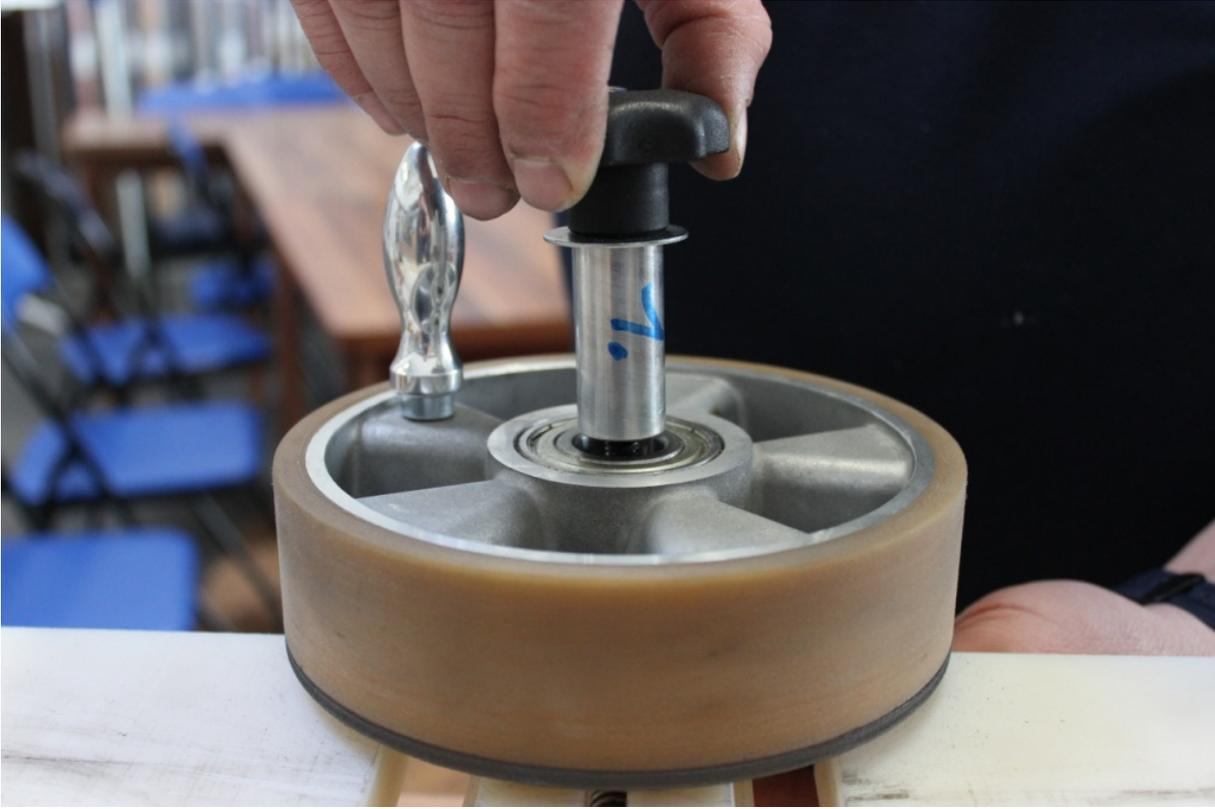
Für die beiden großen Rollen sind die zwei Feststellschrauben zu verwenden.
